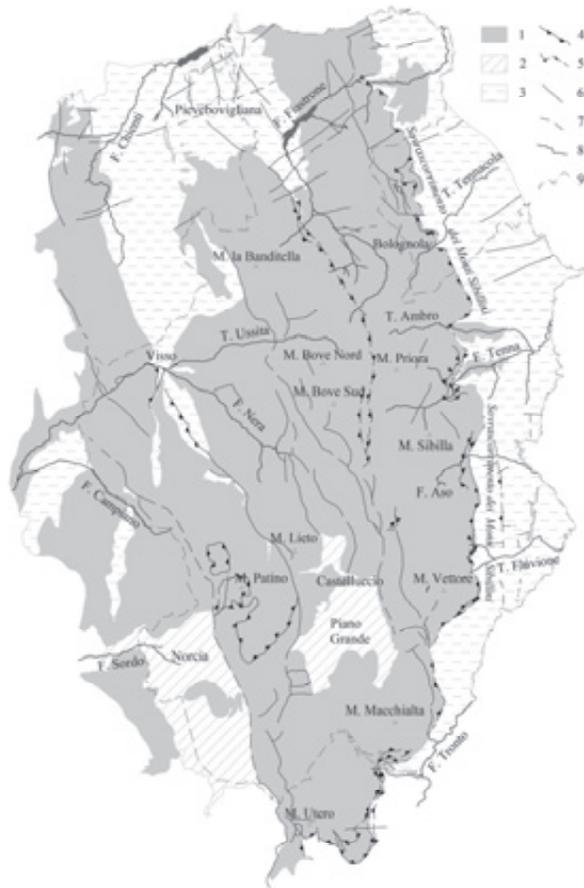
Fig. 1 – Assetto geologico-strutturale dell'area di studio. LEGENDA: 1) dorsali carbonatiche; 2) depositi a bassa permeabilità; 3) piane intramontane; 4) sovrascorrimento; 5) sovrascorrimento presunto; 6) faglia; 7) faglia presunta; 8) corso d'acqua; 9) limite dell'area del Parco Nazionale dei Monti Sibillini.
