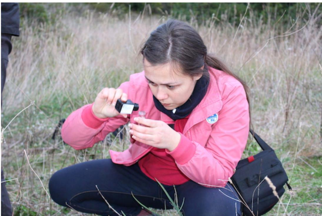
**Figura 6.8: Determinazione della concentrazione di ammoniaca in un campione d'acqua.**
