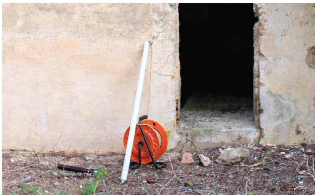
**Figura 6.5: Campionamento con Bailer in uno dei pozzi dell'Isola di Pianosa.**
