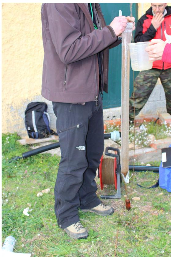
**Figura 6.6: Campionamento con utilizzo dell'Hydrasleeve in un pozzo.**
