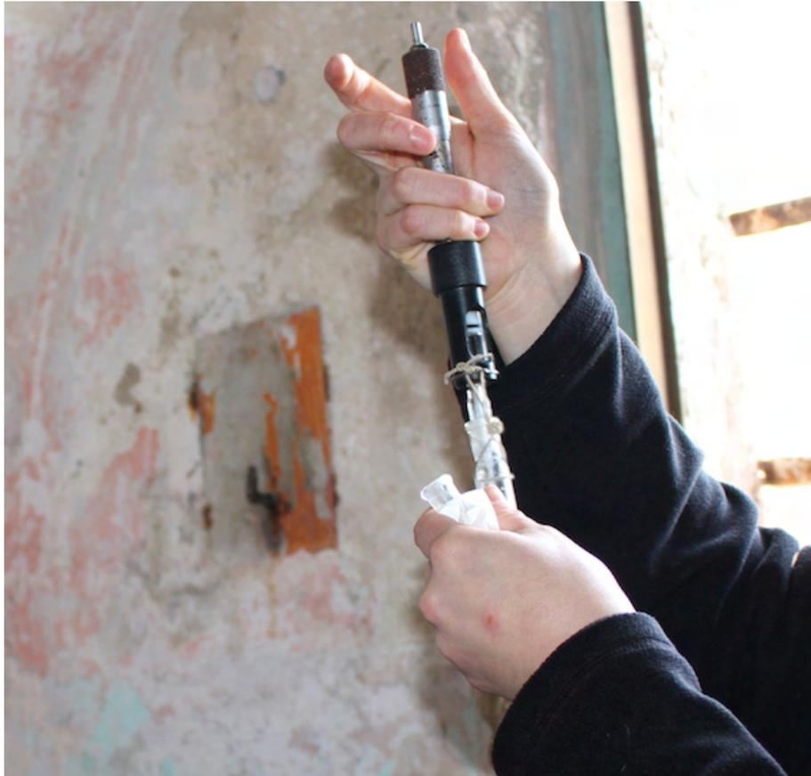
**Figura 6.7:** Titolazione acido-base con l'utilizzo di un microdosimetro per la determinazione dell'alcalinità.
