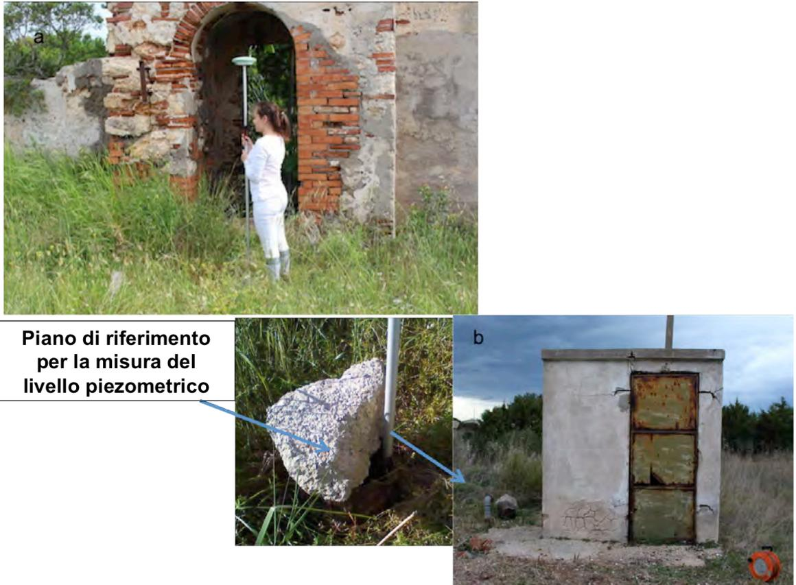
Figura 6.2: a) Sistema GPS utilizzato per la registrazione del piano di riferimento; b) Registrazione del piano di riferimento per un pozzo.
