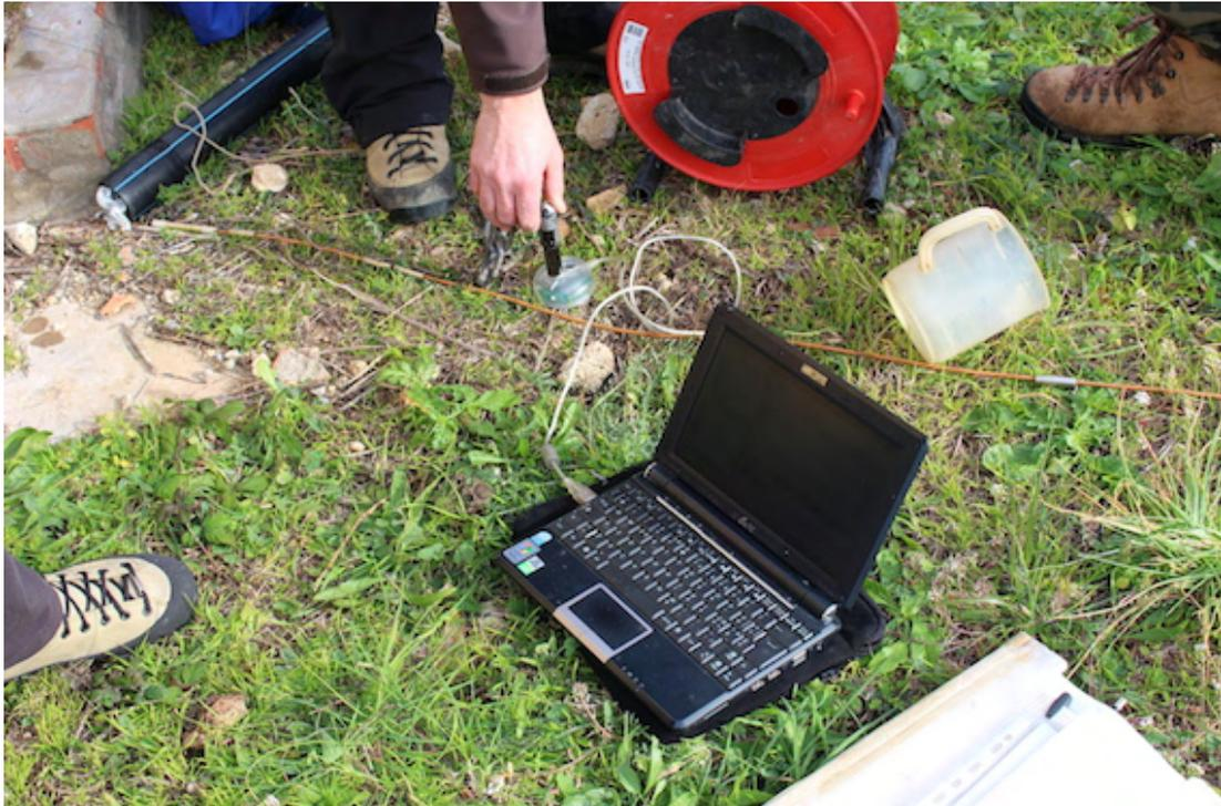
**Figura 6.12: Trasferimento dei dati di un diver con l'apposito strumento presso l'Isola di Pianosa.**
