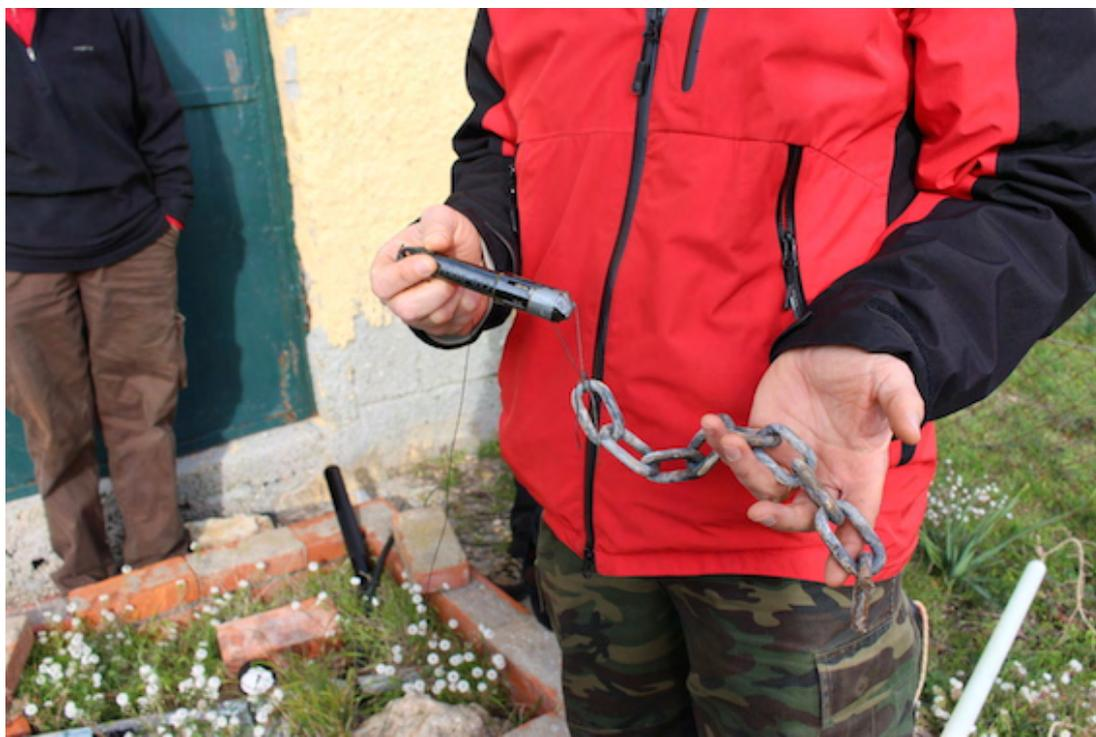
**Figura 6.11:** Esempio di una sonda multiparametrica, in particolare un CTDD diver, appena tolta da un pozzo per effettuare il trasferimento dei dati.
