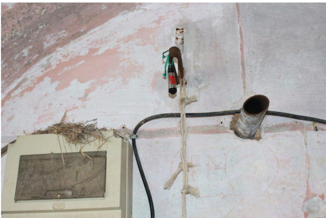
**Figura 6.13: Baro-diver collocato nell'edificio del PN12.**
