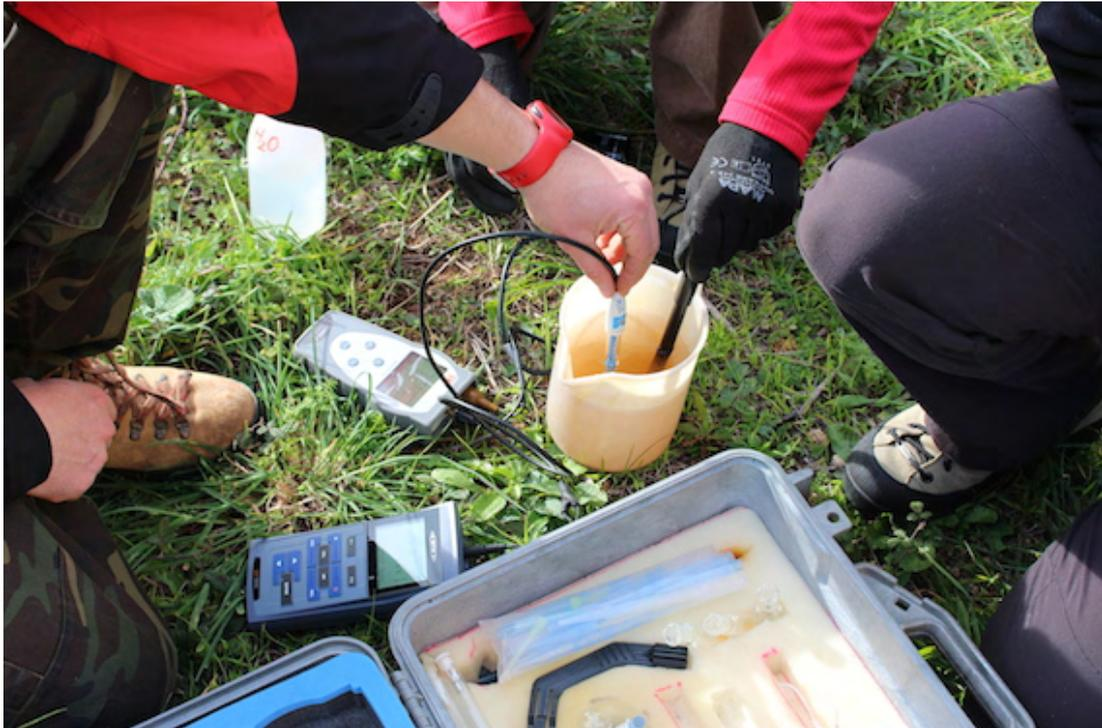
**Figura 6.4: Misurazione di temperatura, pH e conducibilità elettrica con l'utilizzo di un pHmetro e di un conducimetro di un campione di acqua.**
