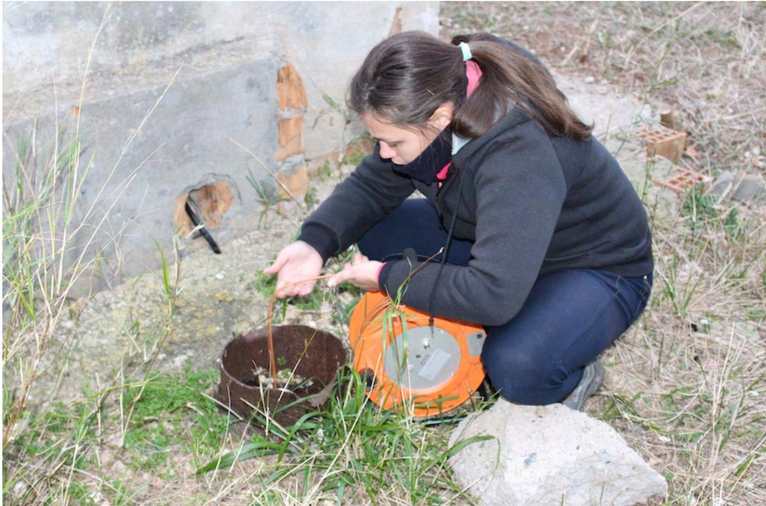
**Figura 6.1: Misurazione del livello piezometrico di un pozzo con l'utilizzo di un freaticometro.**
