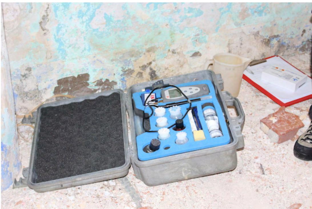
**Figura 6.3:** Valigetta con tutto il necessario per la misura in situ di alcuni parametri chimico-fisici e campionamento delle acque.
