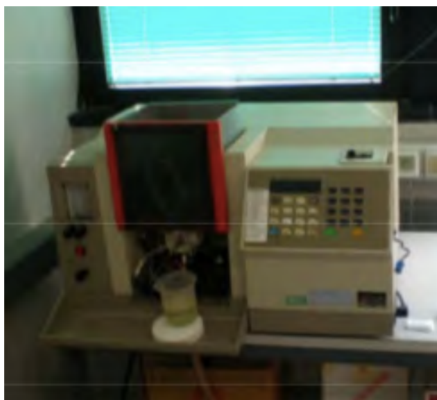
Figura 4: Strumento per effettuare la tecnica dell'assorbimento atomico, che si trova in dotazione del laboratorio del CNR di Pisa (IGG Istituto di Geoscienze e Georisorse).
