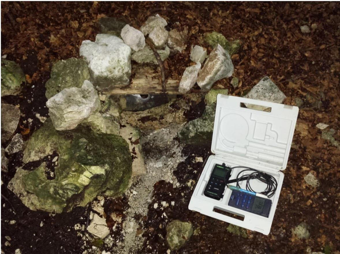
Figura 3.4 – Sonde multiparametriche. La sonda a sinistra misura il pH, quella a destra la conducibilità elettrica e la temperatura.
