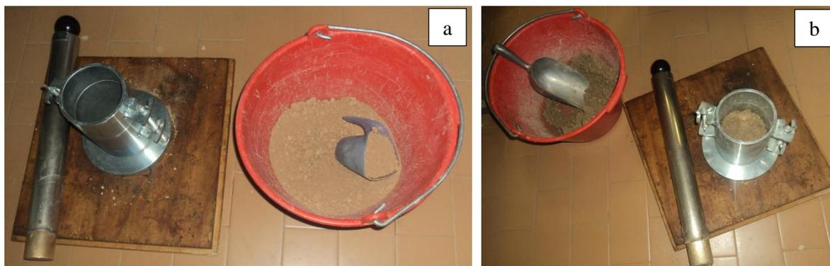
Figura 3.12 – Prova di compattazione proctor: a) fustella cilindrica e maglio; b) primo strato di terreno compattato.
