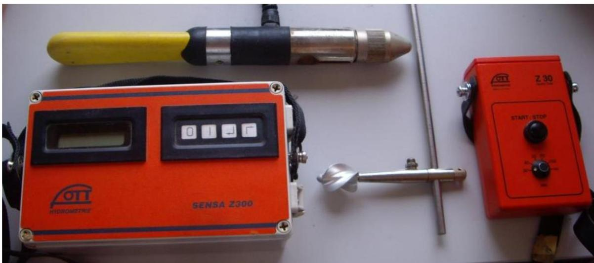
Figura 3.1 – Mulinello ad induzione elettromagnetica (a sinistra) e micromulinello (a destra) con relativi contatori.
