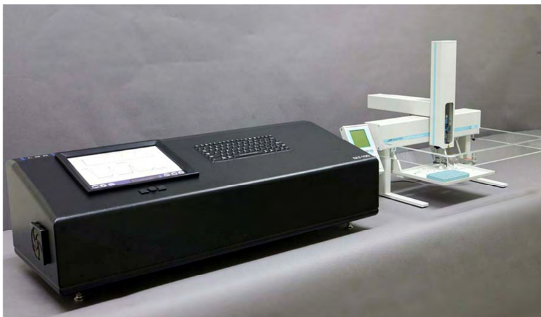
Figura 4.14: Analizzatore di isotopi DLT-100 della ditta Los Gatos Research, collegato al sistema di auto-iniezione LC PAL.
