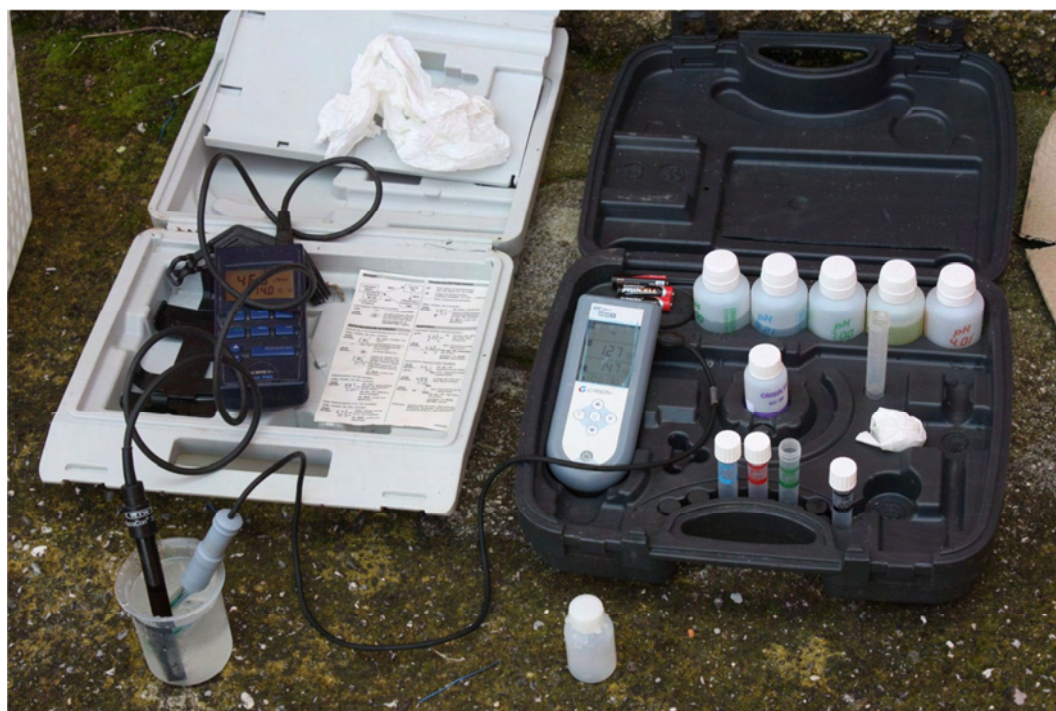
Figura 4.11: Misura dei parametri chimico-fisici dell'acqua al momento del prelievo del campione. Nella foto si stanno misurando temperatura [°C] e conducibilità elettrica [ \mu\text{S}/\text{cm} ] con sonda mobile WTW (a sinistra), pH ed Eh [mV] con lo strumento della Crison Instruments (a destra). (foto di Zavagno E.)
