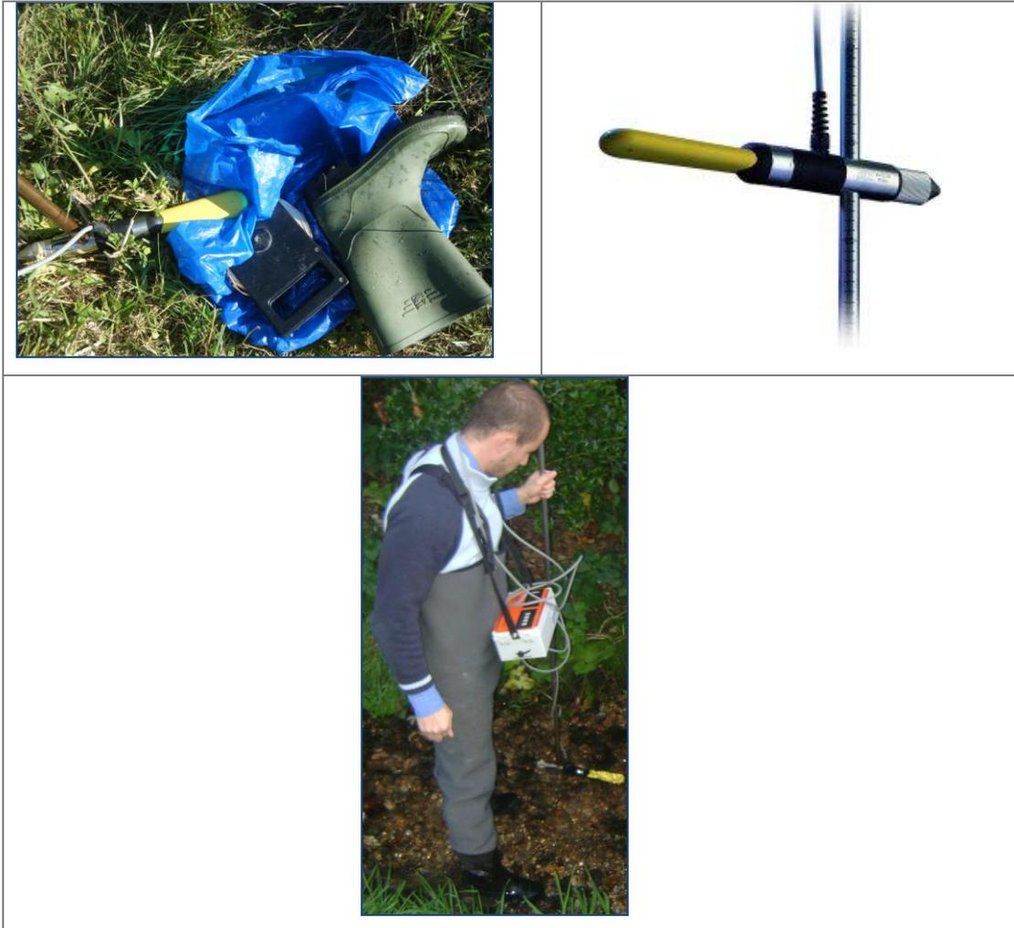
**Fig. 8** – *Strumentazione utilizzata per le misure di portata*
