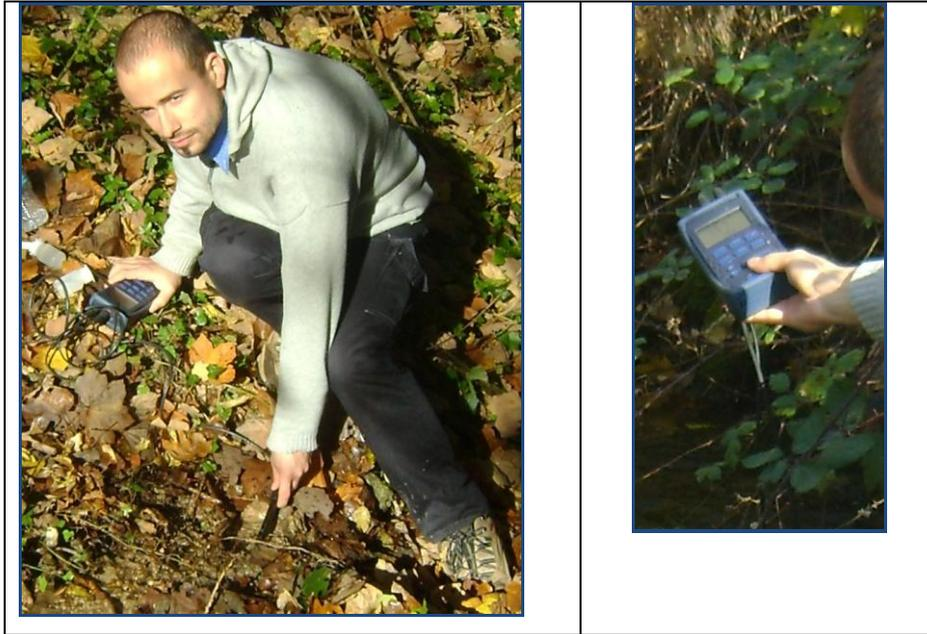
**Fig. 10** – Unità multiparametrica per la misurazione dei parametri idrochimici in situ.
