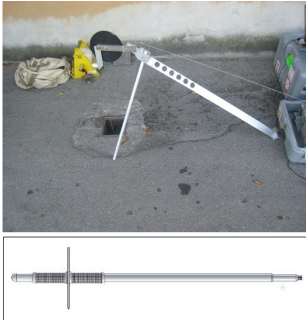
Figura 2.6 – Sonda Heat-pulse flowmeter (in basso) e stazione di misura con verricello (in alto)
